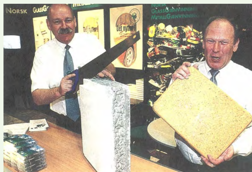
RESIRKULERT GLASS: Jacob Smith demonstrerer bygningsklosser av skumglass, som kan tilpasses med vanlig snekkersag, mens Lasse Sunde viser frem betong med glasstilslag. Foto: Aslak Øverås
